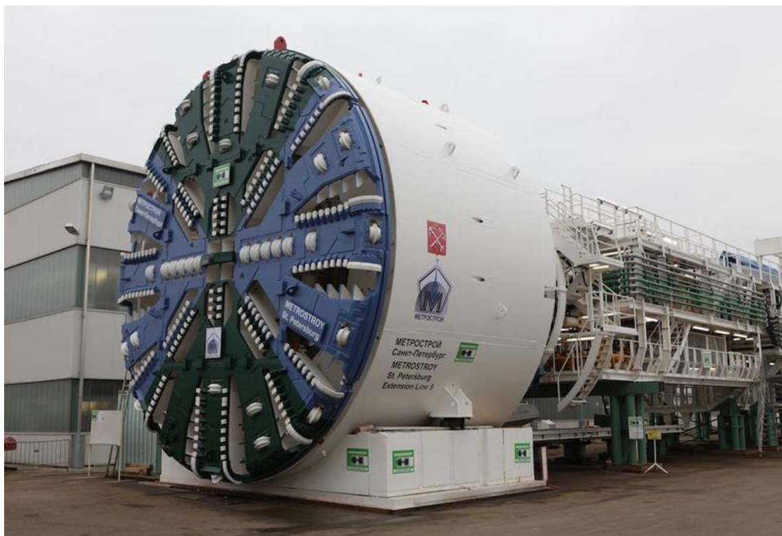
7 - сурет – КТ-5,6 механикаландырылған қалқанмен кенжарды қазу
